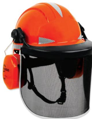
Kit casco forestal compuesto por un casco EVOLITE ABS con ajuste arnés por rueda, soporte y visera tipo gasa alambre de 20 cm, protector oídos EXV de SNR28dB, protector textil de cuello, barboquejo y tiras reflectantes CR2.
