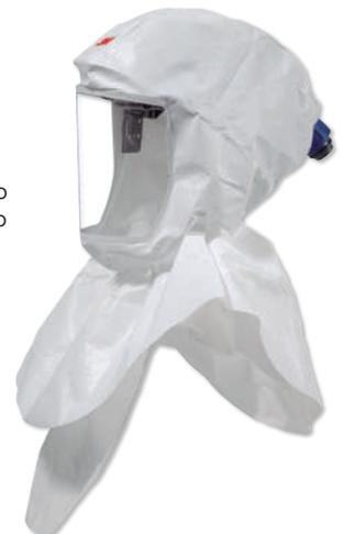
Capucha con doble babero para una estanqueidad perfecta. | Tejido de polipropileno recubierto de polipropileno. Visor de policarbonato tratado. Clase TH3.
