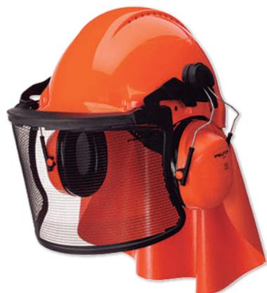
Kit casco forestal compuesto por un casco G3000, soporte y visor malla acero inoxidable de 15,5 cm, protector oído PELTOR de SNR27dB, protector textil de cuello.
