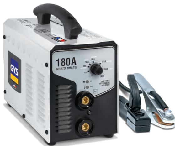
El PROGYS 180A es un equipo de soldadura con electrodo invertido, fácil de transportar y sencillo de utilizar. Ajuste automático de la soldadura mediante la configuración del tamaño del electrodo. Dispone de 3 funciones para facilitar el trabajo del usuario: Hot Start, Arc Force y Antisticking proporcionan asistencia al inicio de la soldadura y durante todo el proceso.
