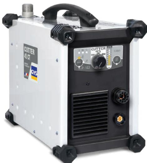
El cortador de plasma polivalente de calidad profesional CUTTER 45 CT se caracteriza por su capacidad de cortar metal hasta 30 mm de espesor. La interfaz CNC y la antorcha industrial automática AT-70 permite una operación mecanizada.
