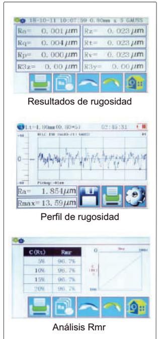
Los datos se pueden enviar a Excel mediante la conexión a la computadora a través de bluetooth o cable SPC
