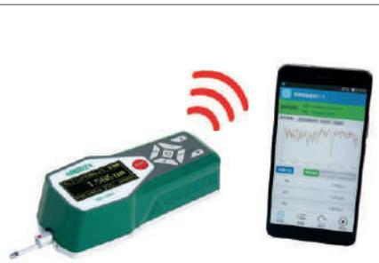
conectarse a teléfonos móviles a través de bluetooth (solo sistema Android), para mostrar valores de rugosidad, perfil y curva
